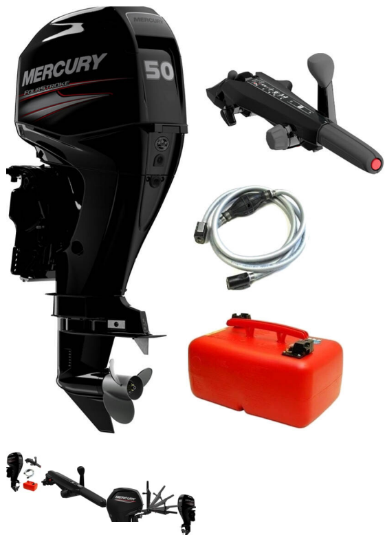
Silnik zaburtowy Mercury FourStroke F50 ELHPT EFI (długość stopa 20") Power Trim, rumpel - MID TILLER
